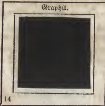
Kohle, die sehr schwierig brennt, einen metallischen Glanz hat und sich weich wie Talc anfühlt. Um ihn zu Bleistiften zu verarbeiten, wird er sehr fein gerieben, mit irgend einem Bindungsmittel zu einer steifen Masse zusammen geknetet, in eine Form gedrückt, getrocknet, zersägt und dann in Holz gefaßt. Nach einer
